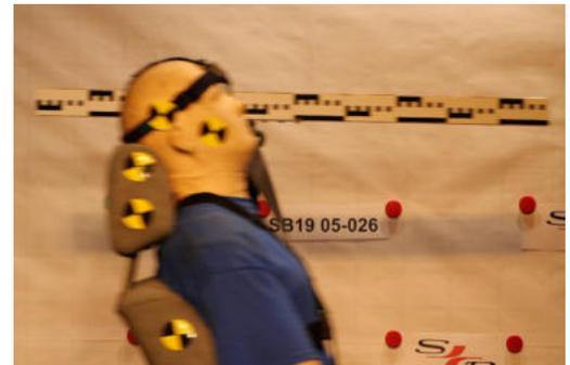
Abb. 9: Messung der Kopfbeschleunigung des Dummy (VW Golf II-Sitz)
