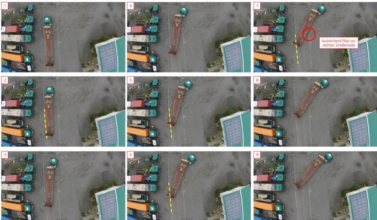
Abb. 4: Topansicht vom Abbiegevorgang eines Sattelzugspanns, es kommt zur Überschreitung der Linie und damit zur Kollision
