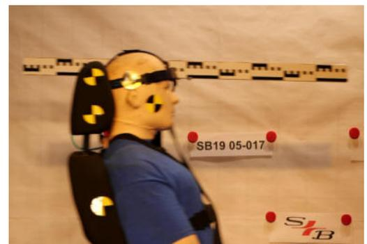
Abb. 10: Messung der Kopfbeschleunigung des Dummy (VW Golf VII-Sitz)
