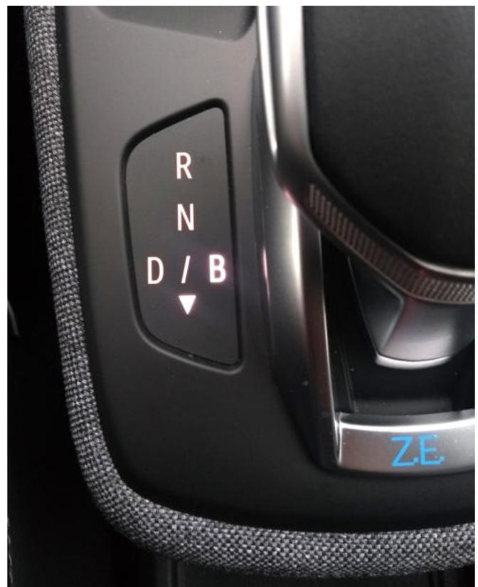
Abb. 2: Betriebsmodi am Wählhebel des Renault Zoe PH2
