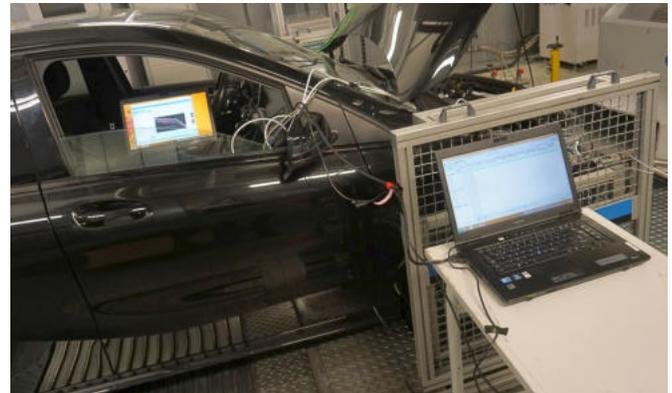
Abb. 2: Messung auf einem Abgasprüfstand, die gezeigten Notebooks zeichnen die Daten der unabhängigen Messdatenerfassung auf
