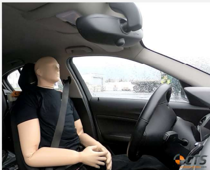
Aufbau eines biofiden Dummies für Crashversuche mit Beschleunigungssensoren [Quelle: S+B-Untersuchung und CTS]
