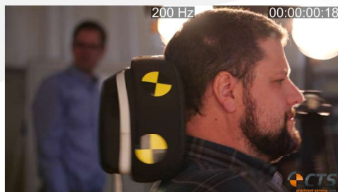
Passives Auslösen der Kopfstütze beim Opel Insignia bei \Delta v = 11 km/h und einem Körpergewicht von etwa 130 kg [Quelle: S+B-Untersuchung]
