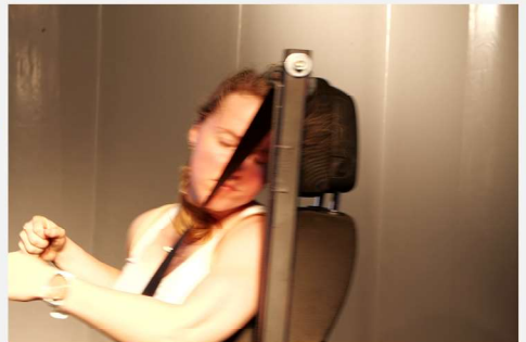
Unnatürliches Abknicken des Kopfes und Überdehnung der rechten Halsseite bei \Delta v = 8 km/h [Quelle: S+B-Untersuchung]
