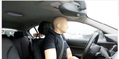
Crashversuch zur Insassenbelastung: Kopfanprall in der Reboundbewegung einer Heckkollision bei \Delta v = 15 \text{ km/h} [Quelle: CTS]
