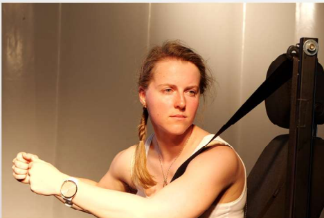
Unnatürliches Abknicken des Kopfes und Überdehnung der rechten Halsseite bei \Delta v = 8 km/h [Quelle: S+B-Untersuchung]
