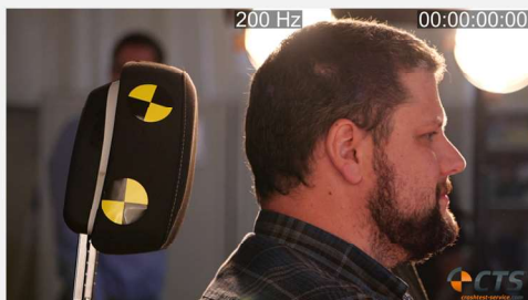
Passives Auslösen der Kopfstütze beim Opel Insignia bei \Delta v = 11 km/h und einem Körpergewicht von etwa 130 kg [Quelle: S+B-Untersuchung]
