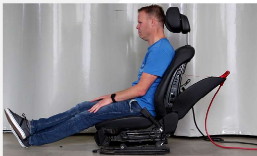
Elektrisches Auslösen des NeckPro-Systems mit anliegendem Kopf
