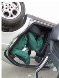
Im Gurt hängender Dummy bei auf dem Dach liegendem Pkw
