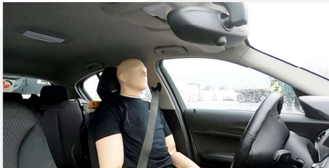
Crashversuch zur Insassenbelastung: Kopfanprall in der Reboundbewegung einer Heckkollision bei \Delta v = 15 \text{ km/h} [Quelle: CTS]
