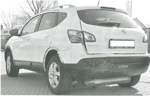
Abb. 2: Schäden am angestoßenen Fahrzeug
