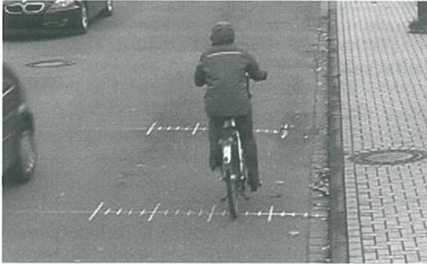
Abb. 7 Messung des Bordsteinabstands vor dem Kanaleinlaufschacht
