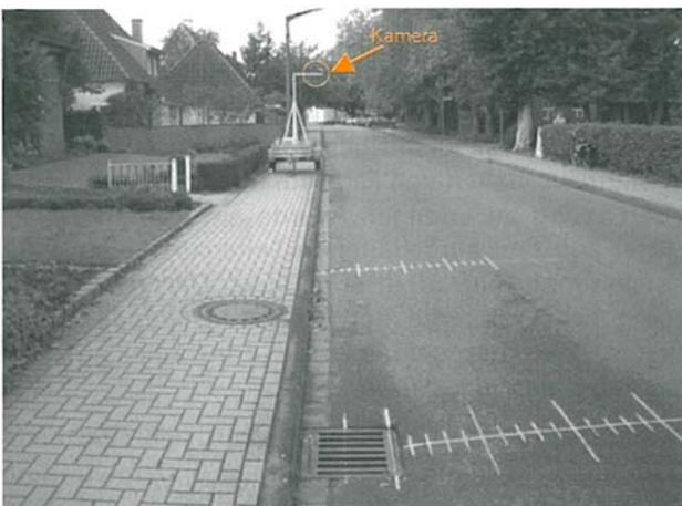
Abb. 6 Abstandsmarkierungen zur Messung des seitlichen Bordsteinabstands vor und direkt am Kanaleinlaufschacht
