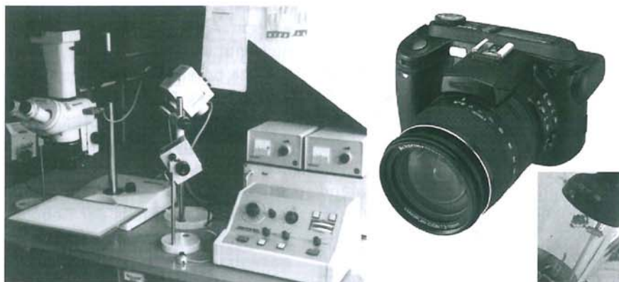
Abb. 1 Stereo-Lichtmikroskop mit Fotoaufsatz [4], Abb. 2 Digitalkamera (Macroaufnahme)
