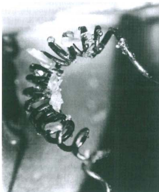
Abb. 4 Abblendlicht mit Glasansmelzungen [4]
