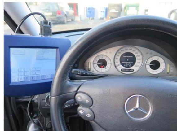
Abb. 2: Verwendung von Tachoprogrammiergeräten
