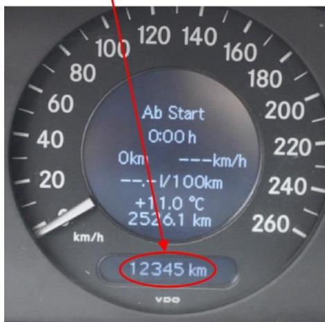
Abb 3: "Korrektur" der Laufleistung von 55.544 km auf 12.345 km an einer Mercedes-Benz E-Klasse (W211)
