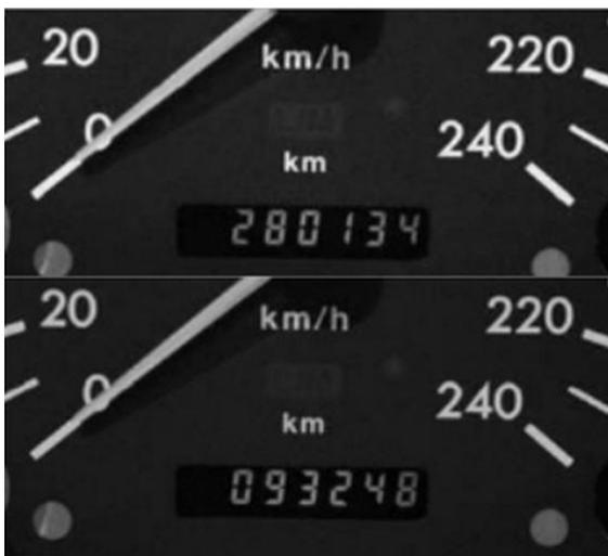
Abb. 1: Untersuchung der Datenprotokolle in einer Tachoeinheit (Mercedes Benz W163) und "Korrektur" der Laufleistung von 280.134 km auf 93.248 km
