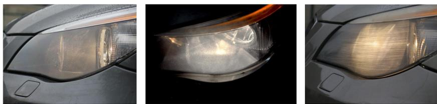
Klarer (links), getrübtter (mitte) und zusätzlich mit Schleifpapier beschädigter BMW-Halogencheinwerfer (rechts) ↑
