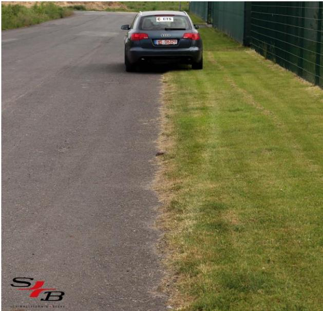
**Abb. 11:** ABS-Reifenspuren auf geteiltem Untergrund (links Asphalt/rechts Rasen), Geschwindigkeit beim Versuch: 30 km/h
