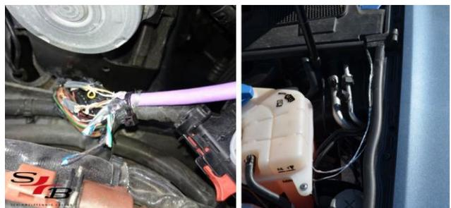
**Abb. 3:** Abgreifen der Signale im Motorraum
