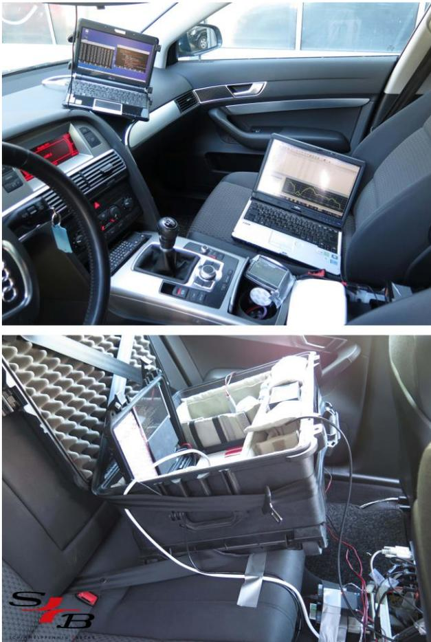
**Abb. 4:** Messrechner & Sensorik (unten) bzw. die Verarbeitung der Messdaten (oben)
