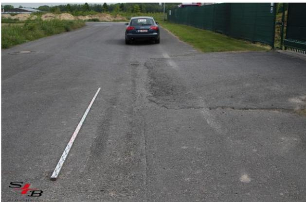
**Abb. 12:** ABS-Reifenspuren auf unebener Fahrbahn mit Rollsplitt, Geschwindigkeit beim Versuch: 70 km/h
