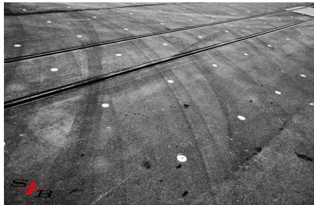
**Abb. 14:** Reifenspuren bei Kreisfahrten mit ESP, Geschwindigkeit beim Versuch: 30 km/h
