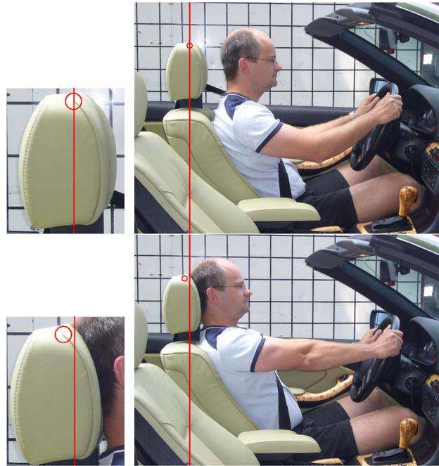
Abb. 4: Vergleich normale Sitzposition (schräge Rückenlehne) – Schutzhaltung RISP (Rear Impact Self Protection)
