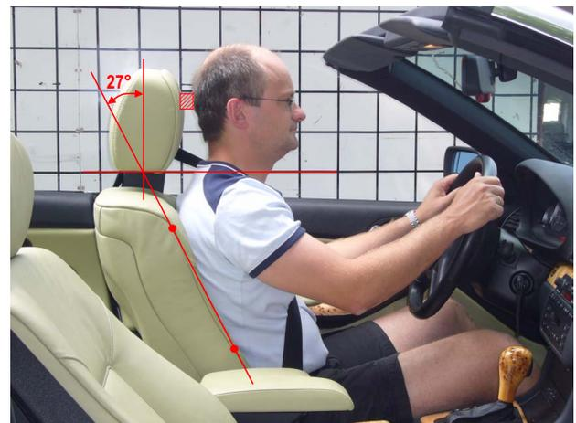
Abb. 3: Einfluss der Rückenlehnenneigung auf den Abstand Kopf/Kopfstütze
