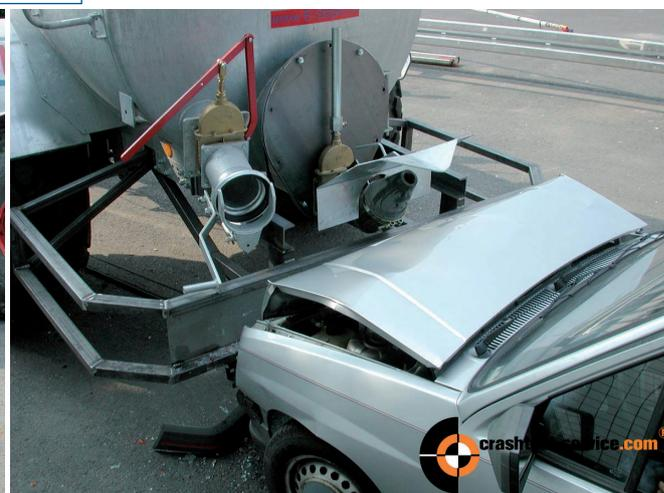
**BILD 8:** Nachgestellte Unfallsituation bei der ein Pkw auf einen Güllefissanhänger auffährt; oben ohne - und unten mit Schutzrahmen
