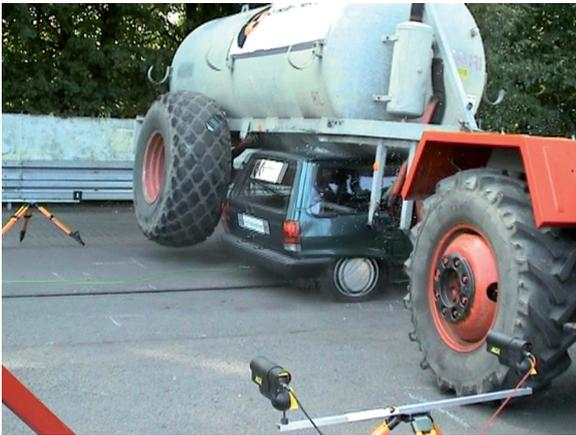
**BILD 10:** Typische Unfallsituation bei fehlendem Seitenunfallschutz
