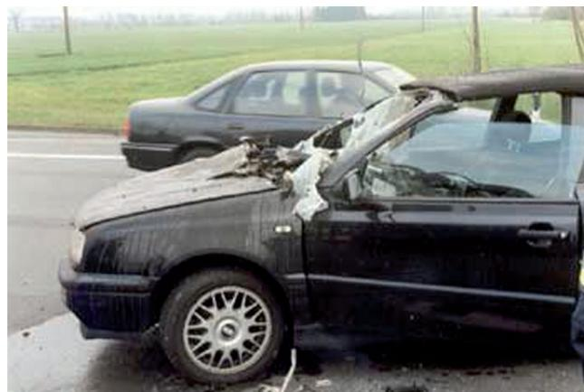
**BILD 7:** Das Sprührohr des Güllefasses durchdringt die Windschutzscheibe des Fahrzeugs
