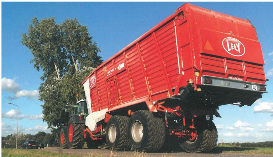
**BILD 4:** Transportanhänger mit langem Überhang und ohne Unterfahrschutz
