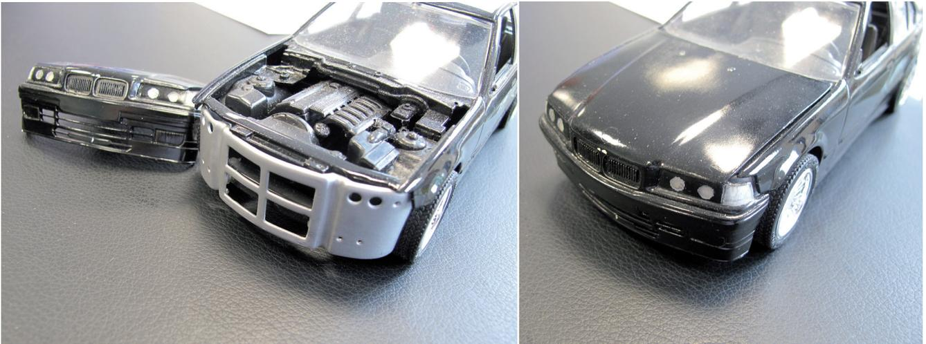
**BILD 3** und **BILD 4**: Hier sieht man das Modell der Deflektorimplementierung aus dem Jahre 1996; die Optik des Fahrzeugs wurde erhalten
