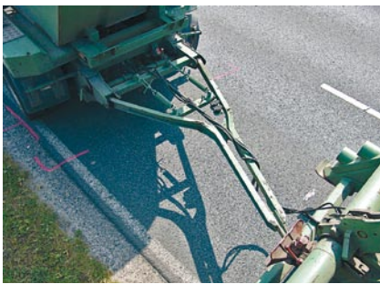
BILD 13: Verformte Deichsel FIGURE 13: Deformed drawbar
