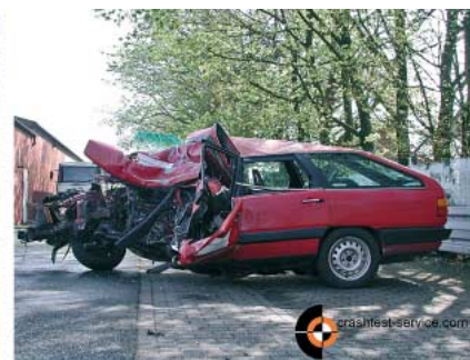
BILD 15: Passender Hochgeschwindigkeitsversuch (EES = 87 km/h)
