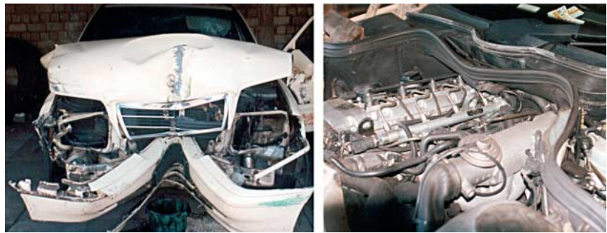
BILD 12: Mittig getroffener Pkw mit Verschiebung des in Längsrichtung eingebauten Motors
