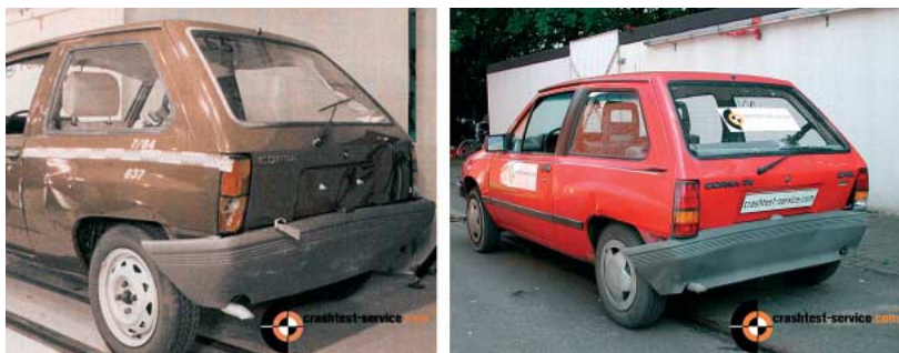
BILD 1: Versuch mit 100 % und und mit 40 % Überdeckung
