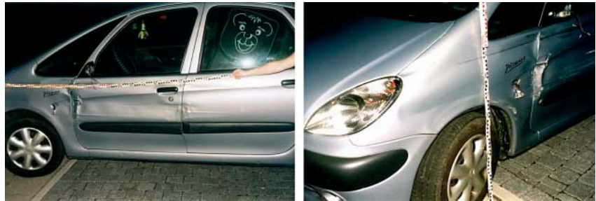
BILD 5: Schadensbeispiel einer Pkw/Pkw-Streifkollision
