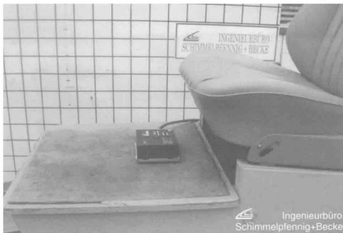
Bild 6 Einbauposition UDS
