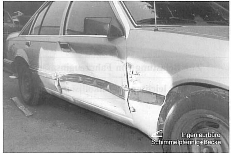
Bild 2 Deformation Opel Rekord, Hauptbelastungsdauer: 0,07 s, mittlere Beschleunigung während der Hauptbelastungsdauer:  $9 \text{ m/s}^2$ , kollisionsbedingte Geschwindigkeitsänderung quer zur Fahrtrichtung: 2,3 km/h
