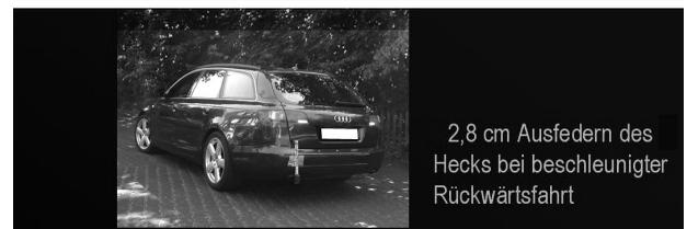
2,8 cm Ausfedern des Hecks bei beschleunigter Rückwärtsfahrt
