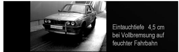
Eintauchtiefe 4,5 cm bei Vollbremsung auf feuchter Fahrbahn
