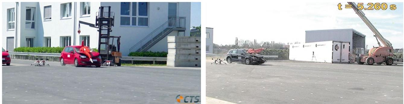
**BILD 2:** Nachstellung (links – Biofidel) der bereits vorhandenen Crashversuche (rechts – konventionell) – Kollisionsgeschwindigkeit hier  $v = 68 \text{ km/h}$
