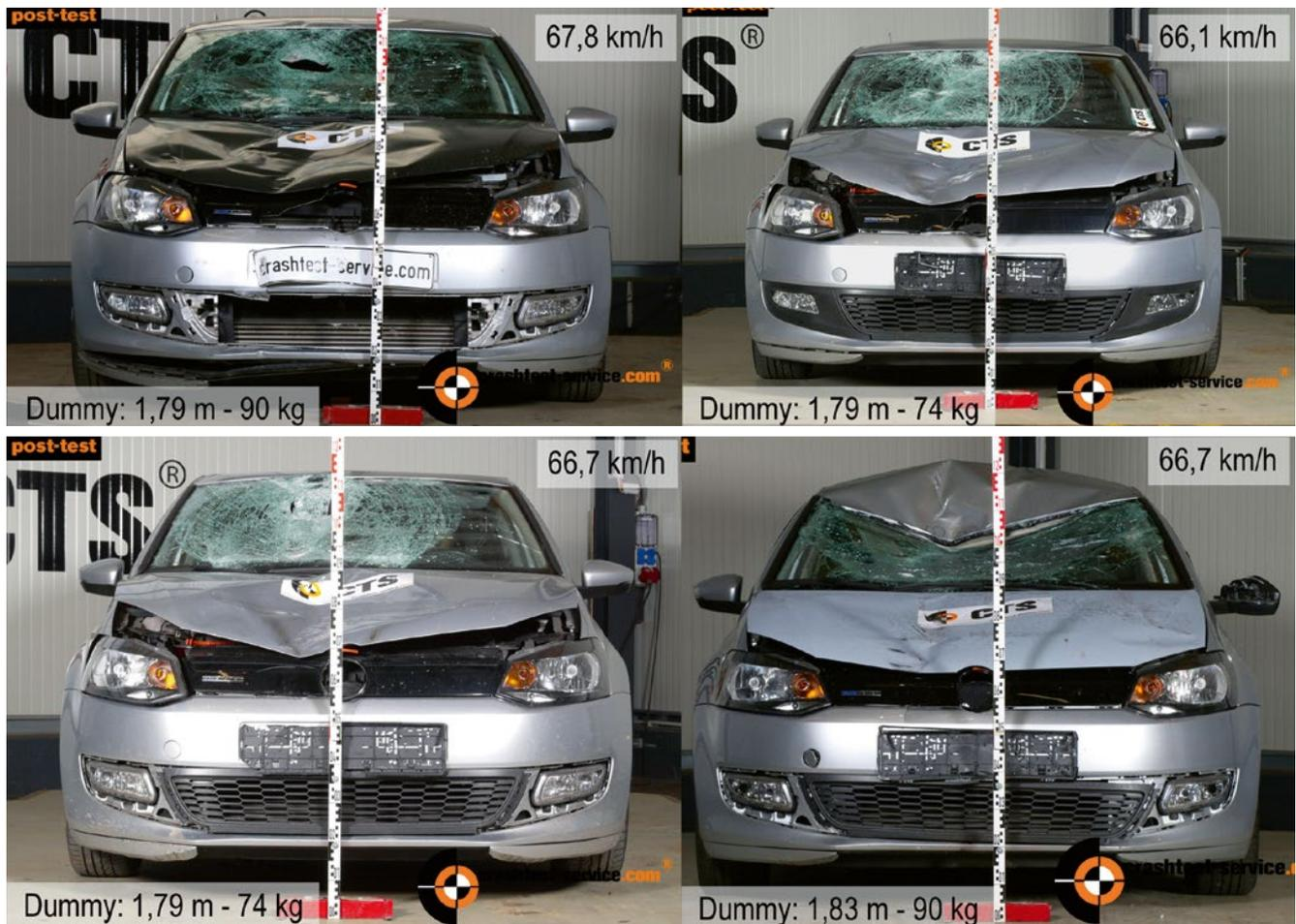
**BILD 9:** Schadenvergleich am VW Polo 6R beim Anprall gegen einen konventionellen Dummy im Geschwindigkeitsbereich von 66 bis 68 km/h
