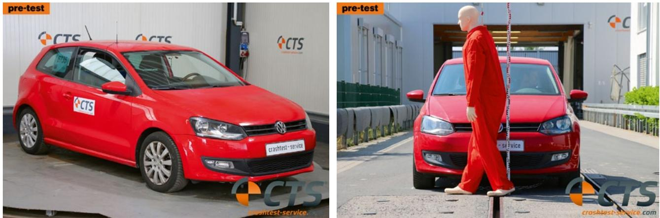
**BILD 1:** Crashfahrzeug VW Polo 6R (links) und Anstoßsituation mit Biofidel-Dummy (rechts) für die durchgeführte Crashserie
