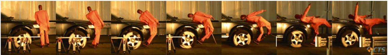
BILD 12: Bewegungsablauf des NAMI-Dummys im Crashversuch mit dem VW Touareg
