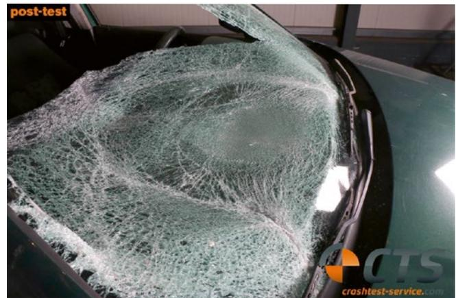
BILD 21: Motorhaubenbeschädigung durch Knieanprall und Bruchspinne in der Frontscheibe
