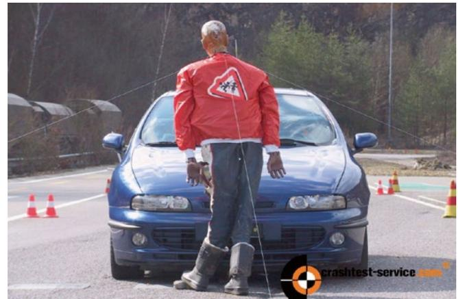
BILD 18: Anstoßkonfiguration beim Frontalanstoß (links Biofidel-, rechts Winterthur-Dummy)
