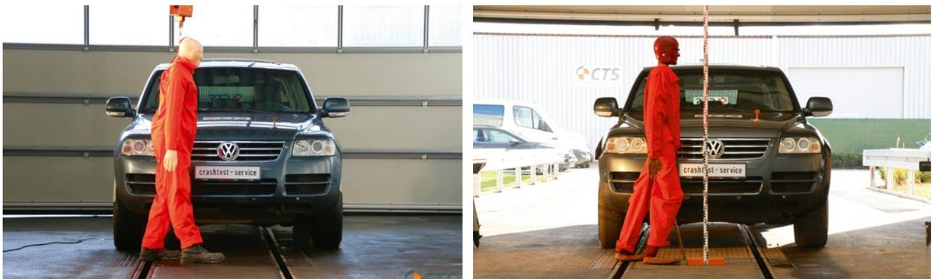
**BILD 10:** Anstoßkonfiguration – Biofidel-Dummy links, NAMI-Dummy rechts
