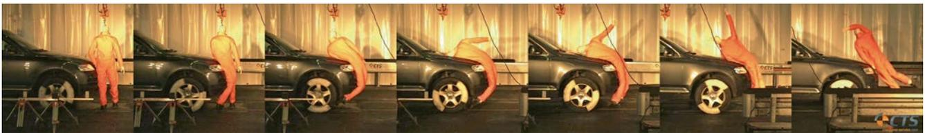
BILD 11: Bewegungsablauf des Biofidel-Dummys im Crashversuch mit dem VW Touareg
