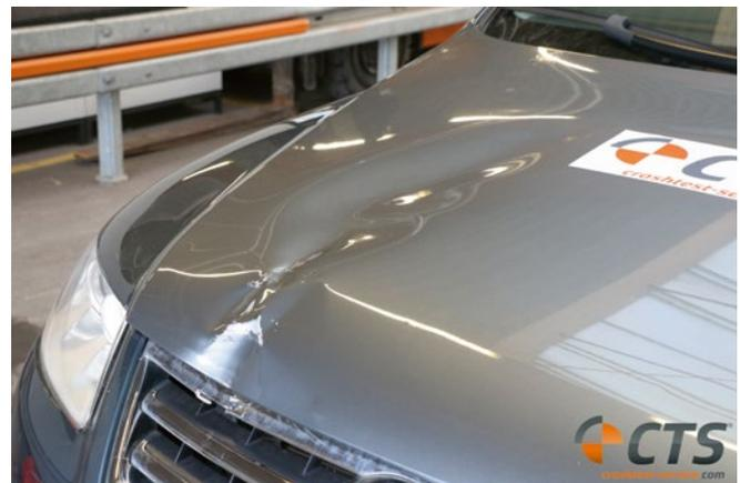
**BILD 15:** Motorhaubenschaden (links Biofidel, rechts NAMI)
