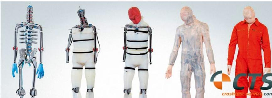
**BILD 2:** Beispielformen der Fertigungsstufen des Biofidel-Dummys
