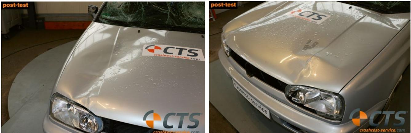
**BILD 8:** Kontaktsuren auf der Motorhaube durch den NAMI- (links) und den Biofidel-Dummy (rechts)
