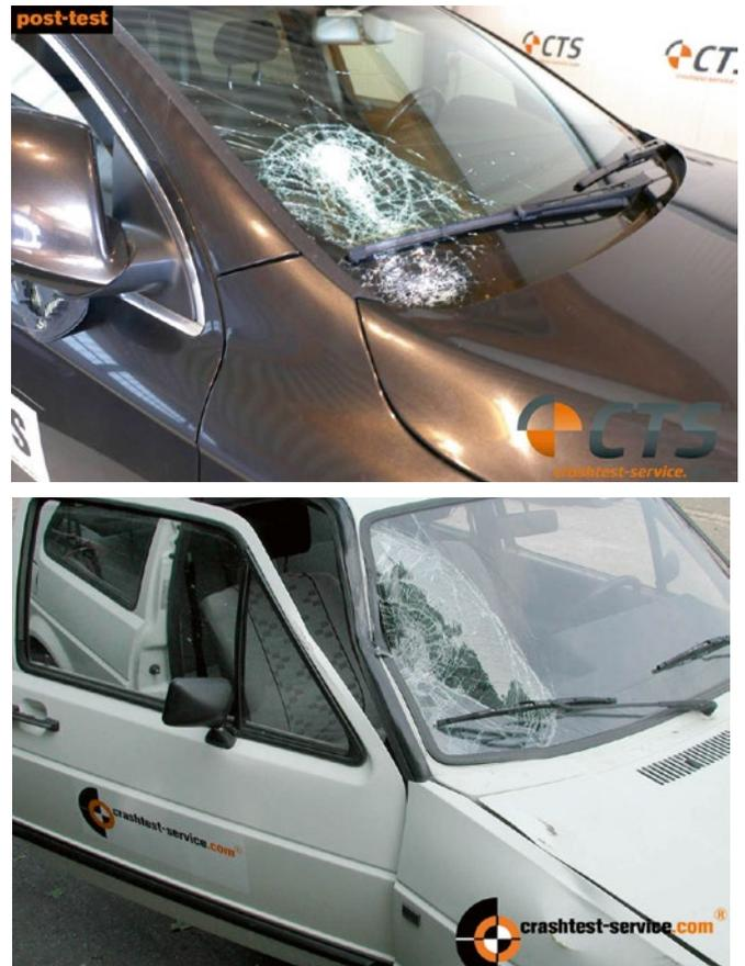
**BILD 23:** Schadenbild im Bereich der Frontscheibe und der A-Säule (Audi oben, VW unten)
