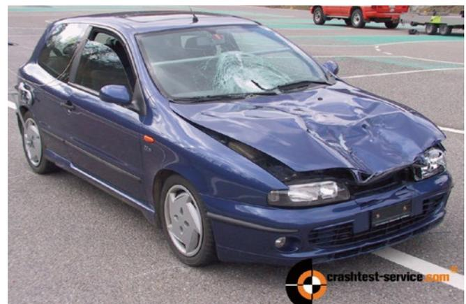
BILD 20: Schadenvergleich VW Bora (links Biofidel) und Fiat Bravo (rechts Winterthur)
