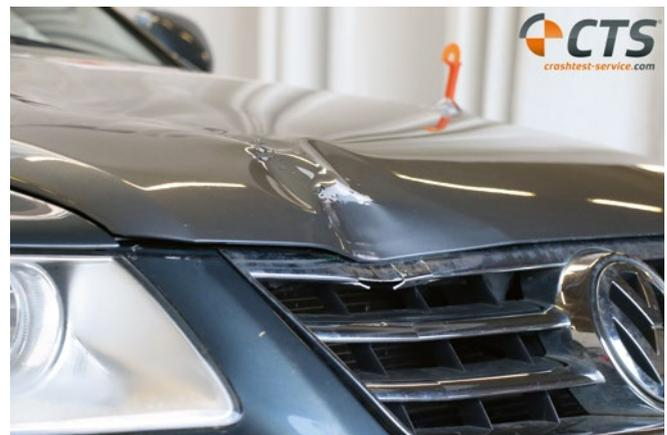
**BILD 16:** Anstoßbereich an der Vorderkante der Motorhaube (links Biofidel, rechts NAMI)
