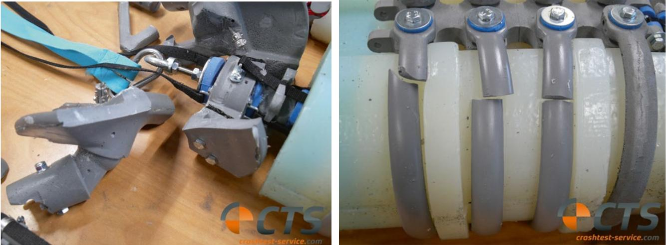
BILD 25: Bildmaterial aus einer „Obduktion“ eines Biofidel-Dummys nach dem Crashversuch
