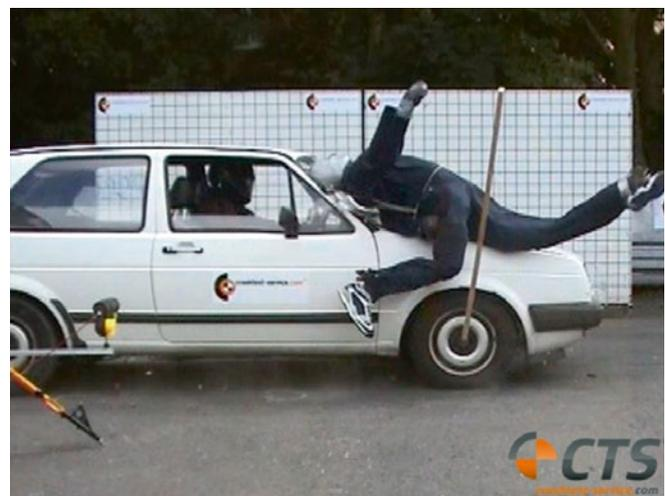
BILD 22: Abgleitende Fußgängerkollision mit einem Biofidel- (links) und einem konventionellen Dummy (rechts)
