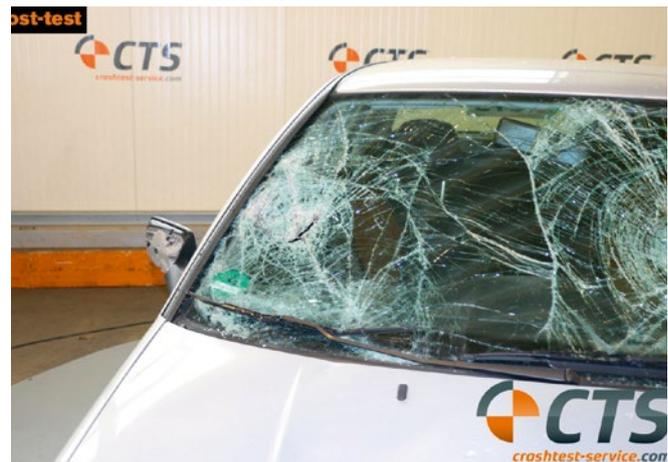
findet. Das typische Unterziehen der Füße ist auch beim Crash mit diesem Fahrzeugtyp gegeben. Im Kollisionsverlauf passt sich der Dummy der Kontur der Fahrzeugfront an, wodurch der Oberkörper von oben auf die Motorhaube drückt und der Kopf in einer seitlichen Nickbewegung mit
