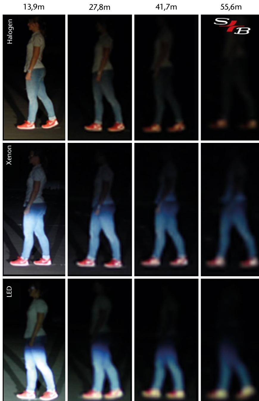
BILD 12: Sichtaufnahmen aus dem Audi mit Halogen-, Xenon- und LED-Scheinwerfern bei Fußgängerannäherung von rechts zwischen 4 und 1 s vor der Kollision
