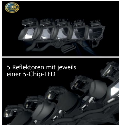
BILD 4: Reflektoren mit jeweils 5 einzeln ansteuer- und dimmbaren LED des Vergleichsscheinwerfers
