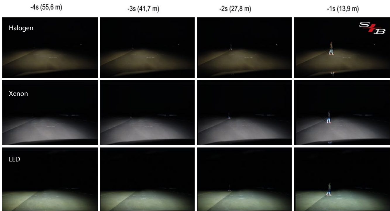
BILD 6: Sichtaufnahmen aus dem Audi mit Halogen-, Xenon- und LED-Scheinwerfern bei Fußgängerannäherung von links zwischen 4 und 1 s vor der Kollision
