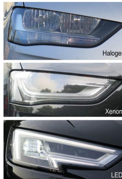
**BILD 2:** Scheinwerferausführungen mit Halogen-, Xenon- und LED-Licht
