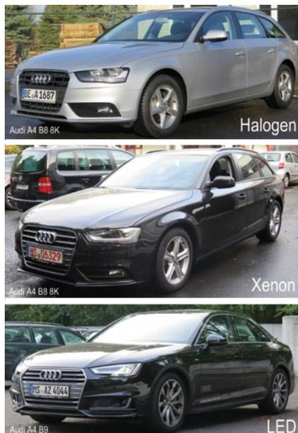
**BILD 1:** Versuchsfahrzeuge Modell Audi A4 mit Halogen-, Xenon- und LED-Scheinwerfern
