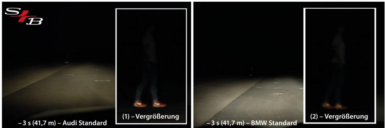
BILD 17: Sichteindruck aus 41,7 m Entfernung mit Audi- (1) und BMW-Standardbeleuchtung (2))
