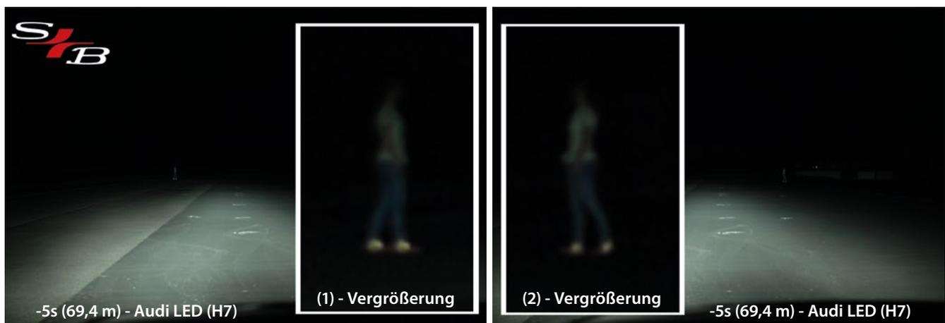
**BILD 19:** Sichteindruck aus 69,7 m Entfernung mit Audi LED (H7) mit Fußgängerannäherung von links (1) und rechts (2)
