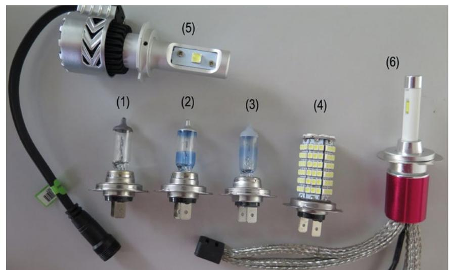
**BILD 4:** Leuchtmitteltest mit (1) Osram original 64210-01B, (2) Osram Night Breaker Unlimited, (3) Philips WhiteVision Xenon-Effekt, (4) Carchet LED, (5) Neverland LED, (6) Car Rover LED
