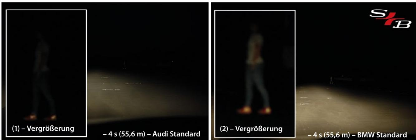
**BILD 16:** Sichteindruck aus 55,6 m Entfernung mit Audi- (1) und BMW-Standardbeleuchtung (2)
