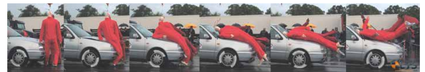
Abb. 5: Bewegungsablauf des Biofidel-Dummys im Crashversuch (gespiegelt)
