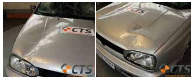
Abb. 8: Kontaktpuren auf der Motorhaube des NAMI (L) und des Biofidel-Dummys (R)
