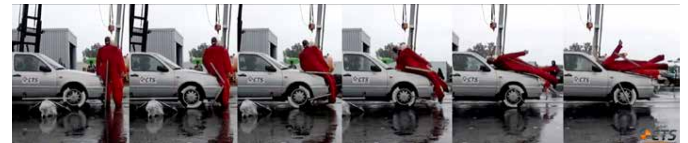
Abb. 4: Bewegungsablauf des NAMI-Dummys im Crashversuch
