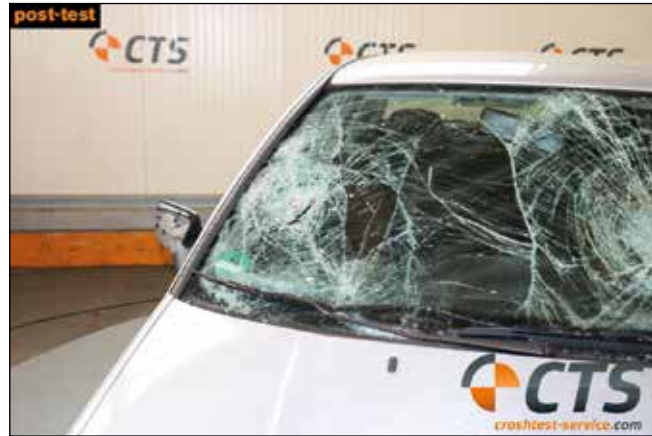
Abb. 7: Bruchbild der Windschutzscheibe
