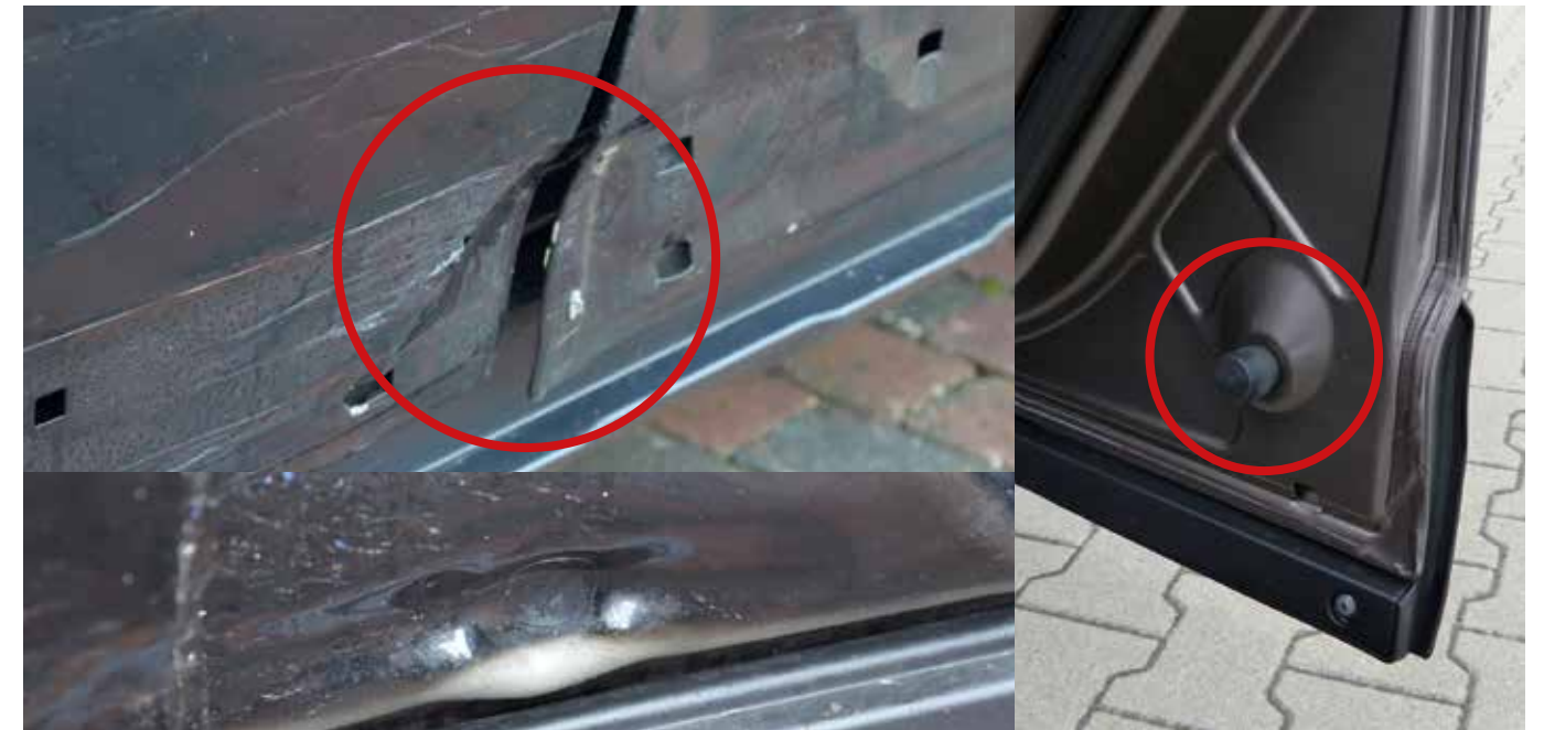
Abb. 2: Schaden an der B-Säule durch den Stutzen in der Tür
