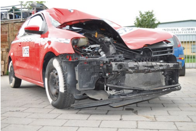
BILD 5: Schaden am VW Polo nach Demontage der Stoßfängerverkleidung
