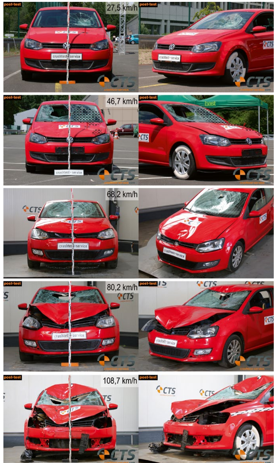
BILD 7: Veränderung des Schadenbilds (Anprall gegen Biofidel) am VW Polo 6R bei steigender Kollisionsgeschwindigkeit von 27,5 bis 108,7 km/h in der Front- und Seitenansicht
