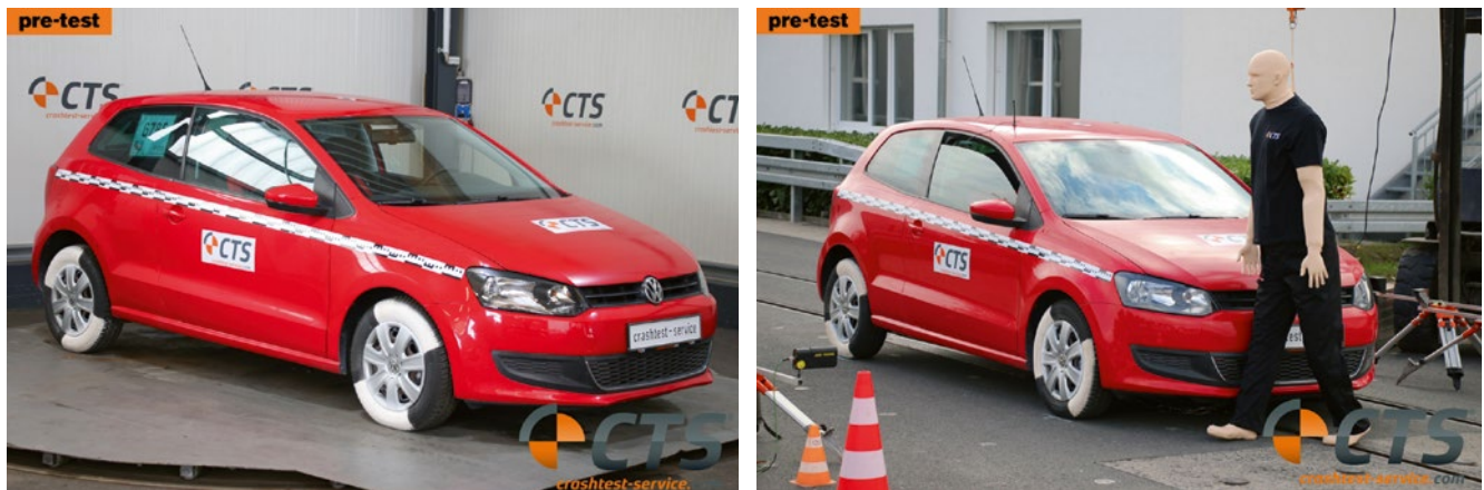
BILD 1: Crashfahrzeug VW Polo 6R (links) und Anstoßsituation mit Biofidel-Dummy (rechts) für den Hochgeschwindigkeitsversuch mit v = 109 \text{ km/h} FIGURE 1: Crash vehicle VW Polo 6R (left) and impact situation with Biofidel dummy (right) for the high-speed test with v = 109 \text{ km/h}
