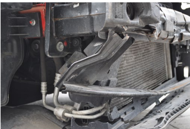
BILD 6: Seitenabhängige Verformung des Bügels gegen das Unterziehen der Füße
