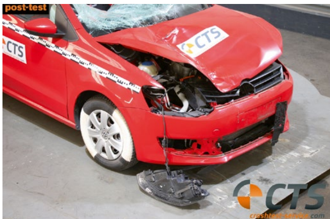
BILD 4: Motorhauben- und Dachbeschädigung am VW Polo bei v = 109 \text{ km/h}
