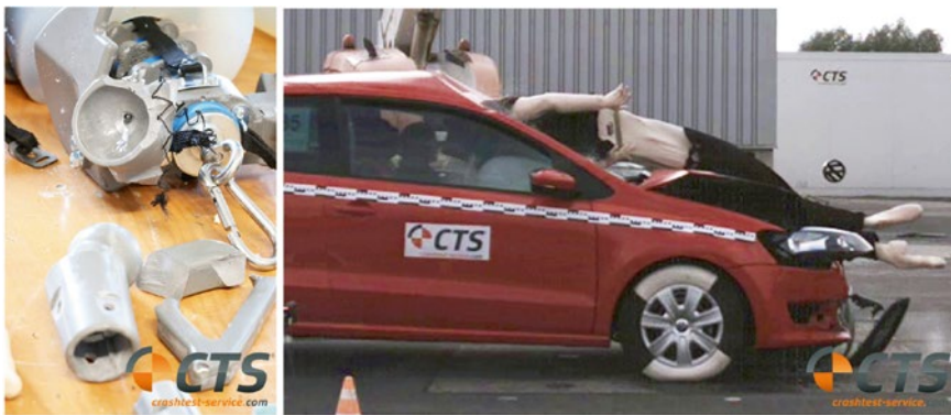
BILD 11: Massive Hüftschädigung (links) und starke Dummy-Längung im Kollisionsverlauf (rechts)
