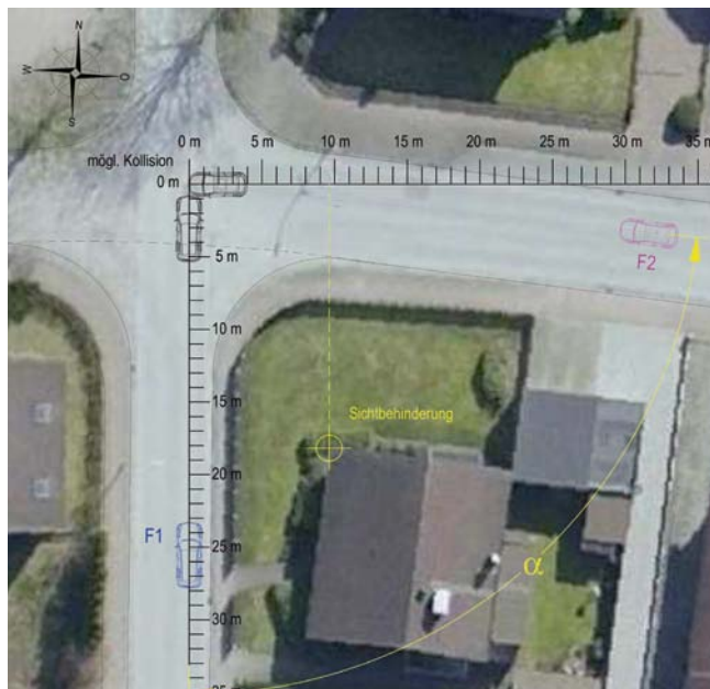
BILD 3: Koordinatensystem zur mathematischen Beschreibung der Fahrvorgänge zum Beispiel der Sichtbehinderung ( x_H/y_H ) FIGURE 3: System of coordinates for the mathematical description of driving processes, for example with obstructed visibility ( x_H/y_H )
