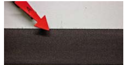
BILD 14: Anschmelzungen Gurtband im Bereich der Schlosszungenumlenkung Opel Kadett E (delta v zirka 26 km/h)
