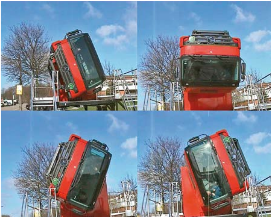
BILD 3: Überschlagssimulator der Berufsgenossenschaft für Fahrzeughaltungen FIGURE 3: Rollover simulator of the Berufsgenossenschaft für Fahrzeughaltungen
