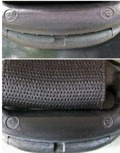
BILD 12: Oberer Umlenkpunkt Opel Astra, oben vor und unten nach frontalem Wandanprall (delta v zirka 21 km/h)
