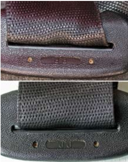
BILD 11: Schlosszungenumlenkpunkt Opel Astra, oben vor und unten nach frontalem Wandanprall (delta v zirka 21 km/h)
