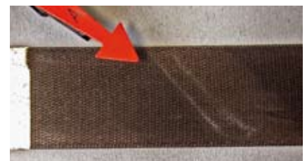
BILD 15: Klemmspuren Gurtband im Bereich der oberen Gurtbandumlenkung Opel Kadett E (delta v zirka 26 km/h)
