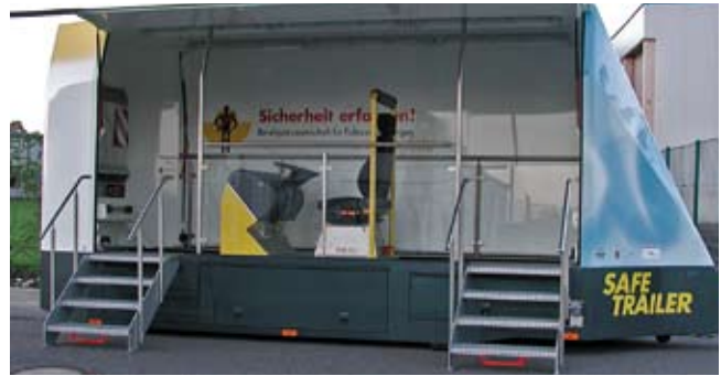
BILD 7: Lkw-Gurtschlitten der Berufsgenossenschaft für Fahrzeughaltungen FIGURE 7: Truck seat belt testing sled of the Berufsgenossenschaft für Fahrzeughaltungen
