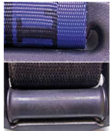
BILD 6: Obere Umlenkpunkte von zwei Sicherheitsgurten eines Überschlagssimulators nach jeweils zirka 7000 Einsätzen FIGURE 6: Upper deviation points of two seat belts of a rollover simulator after approximately 7,000 applications each
