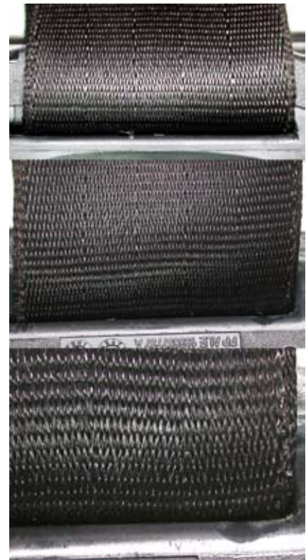
BILD 2: Schlosszungenumlenkpunkt eines VW Fox (Laufleistung: zirka 8000 km)
