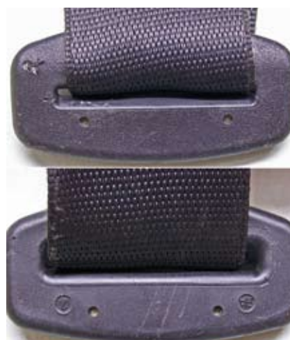
BILD 9: Schlosszungenumlenkpunkt eines Lkw-Gurtschlittens nach zirka 3000 Versuchen FIGURE 9: Lock tongue deviation point of a truck seat belt sled after approximately 3,000 tests
