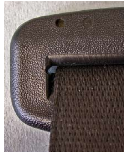
BILD 13: Riefen Schlosszungenumlenkung Opel Kadett E (delta v zirka 26 km/h)
