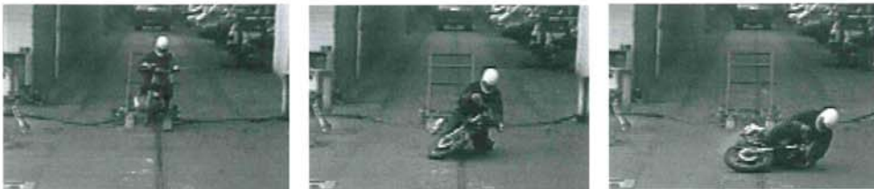
Abb. 2: Sturz bei blockiertem Vorderrad innerhalb von ca. 0,5 sec nach Blockierbeginn
