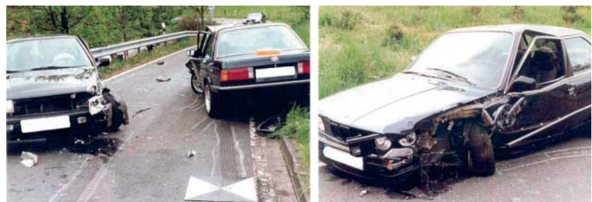
BILD 3: Beispiel für Kollision mit geringer Überdeckung
