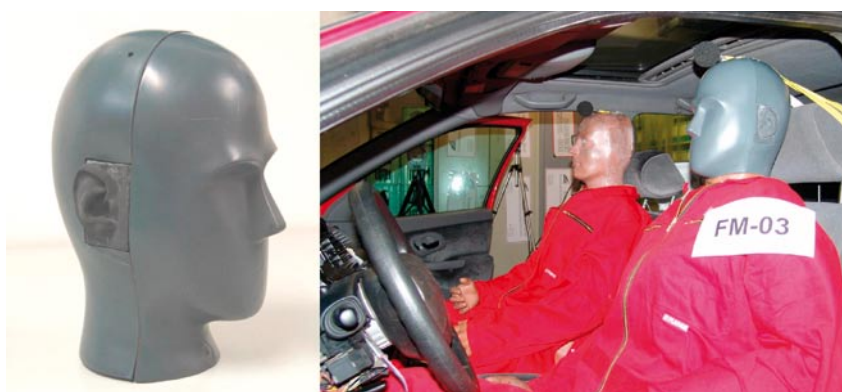
BILD 2: Kunstkopf mit zwei Mikrofonen (links), Dummy mit Kunstkopf (rechts)
